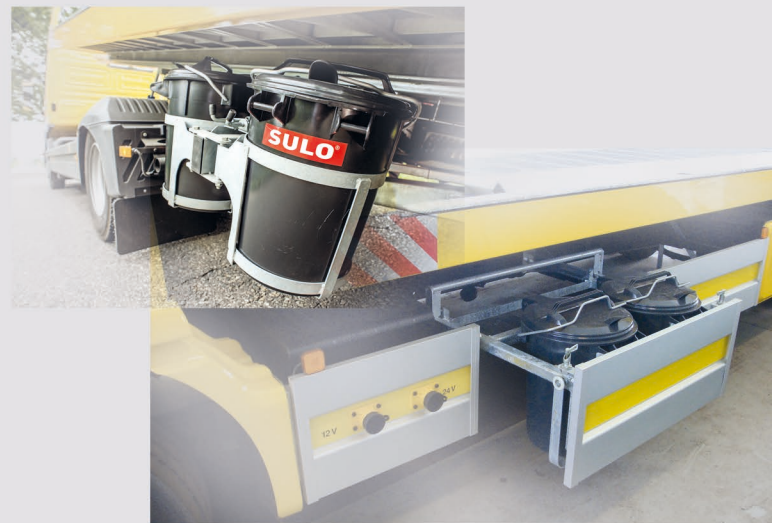
ABS oder Aluminiumkästen für das Werkzeug und das Zubehör / ABS or ALU boxes for tools and accessories
