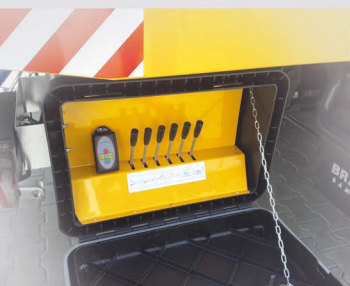
ABS box mit Steuerung und Fernbedienung / ABS box with section control and remote control
